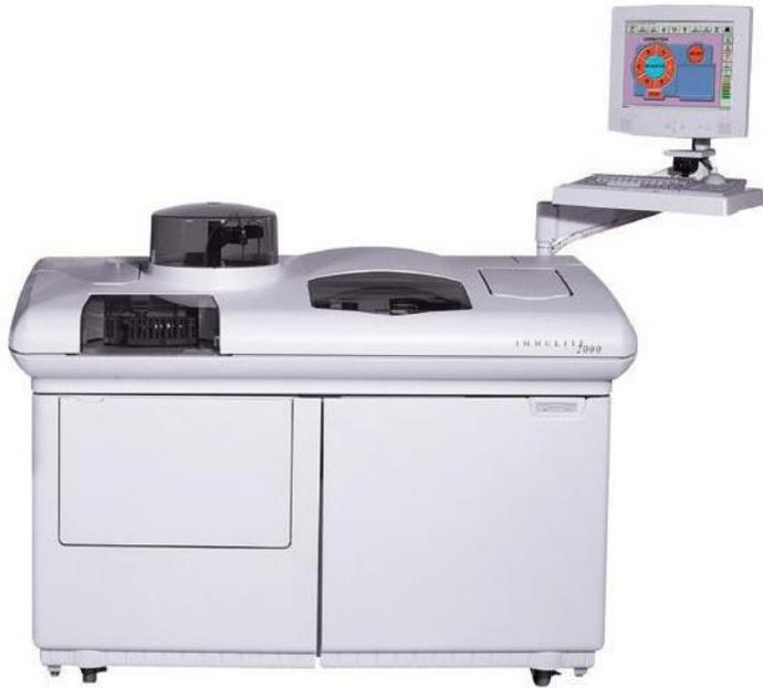
**Immulin 2000** – полностью автоматическая аналитическая система для иммунохимии – для оснащения централизованной КДЛ при планируемой производительности 200 тестов (40-80 проб) в час, что соответствует 350-650 проб в смену (совокупно).
