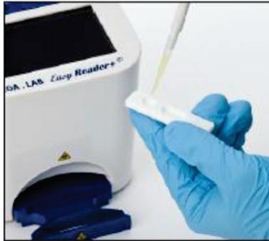
**Рис. 20:** Использование одноразовой пипетки для внесения указанного в инструкции объема пробы в лунку для проб на кассете.
