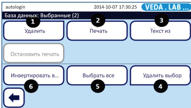
**Рис. 36:** Экран меню **База данных КК>Выбранное (QC Database>Selected)** с отмеченными функциональными кнопками: Удалить (1), Печать (2), Передача (3), Отменить Выбор (4), Выбрать все (5), Инвертировать выбор (6)
