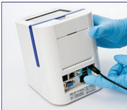
**Рис. 8:** Включите прибор, проверьте соединение шнура питания, включите прибор тумблером на задней панели анализатора (помечен цифрой 11 на [Рис. 2](#)). Удерживайте выключатель нажатым в течение одной секунды.
