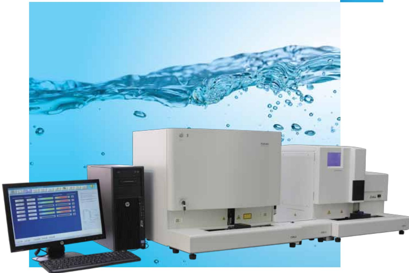
Автоматическая мочева станция DIRUI состоит из 2 приборов – автоматического анализатора мочи H-800 и анализатора осадка мочи FUS-100, соединенных между собой соединительным конвейерным мостиком и объединяет в себе несколько методов исследования мочи.
